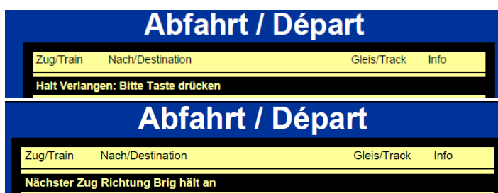
Illustration 29: indications de l'«arrêt sur demande» et de la confirmation de la demande d'arrêt sur le moniteur
