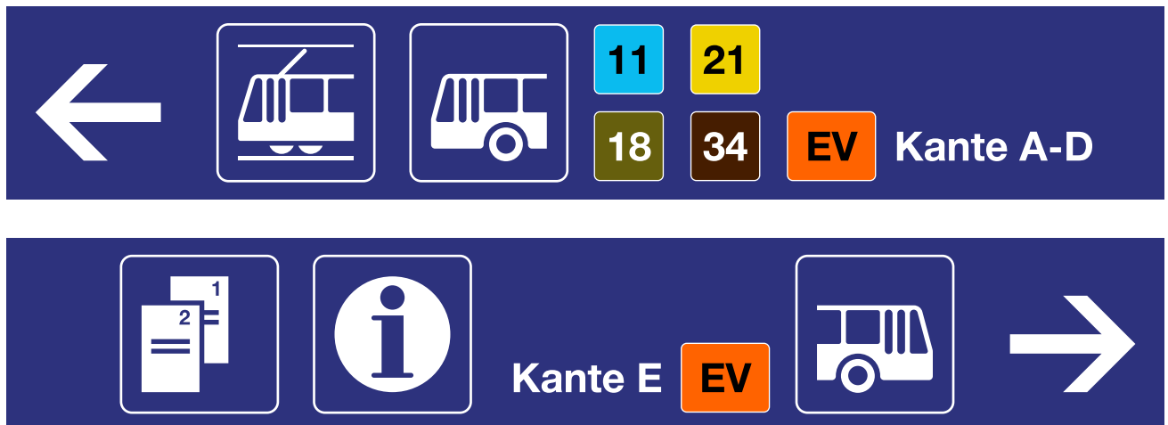
Figure 265: exemple d'indication des lieux de départ des courses de remplacement dans la signalétique en gare (plusieurs lieux)
